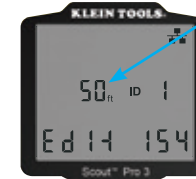
Ajuste la constante de longitud hacia arriba o hacia abajo hasta que la medida de longitud coincida con la longitud conocida del cable de muestra (15 m (50 pies) en este ejemplo)
